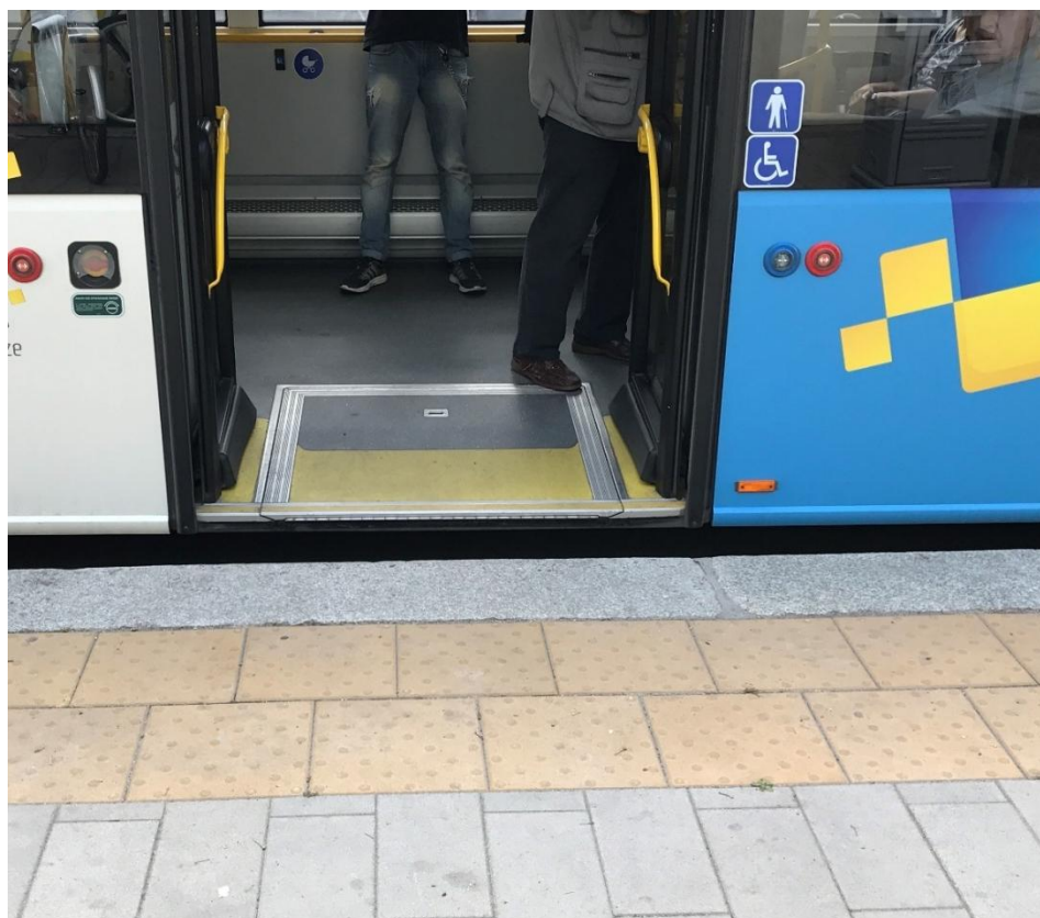
Rys. 9.3 Zminimalizowana przerwa między peronem przystankowym a autobusem
